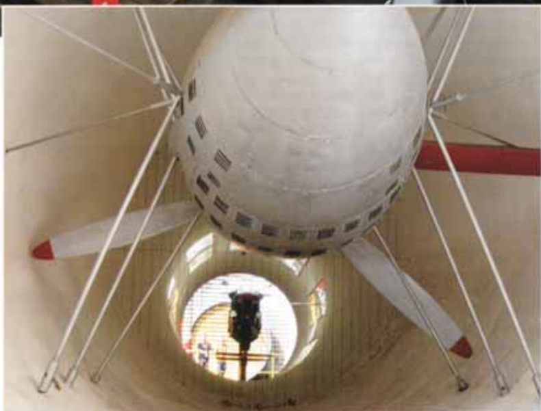
Moto Guzzi è stata la prima casa motociclistica ad avere un proprio impianto per il controllo aerodinamico dei motoveicoli con la Galleria del Vento.
